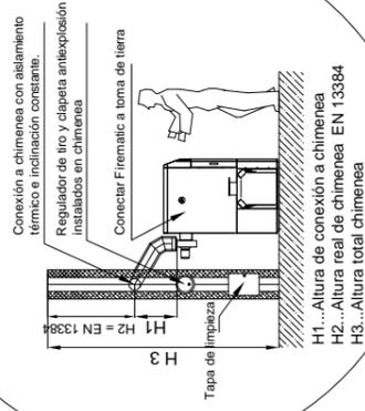
H1...Altura de conexión a chimenea
