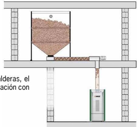
Si el silo textil está situado en una planta superior a la sala de calderas, el transporte de los pellets se realiza mediante un sistema de alimentación con sinfín flexible mediante caída.
