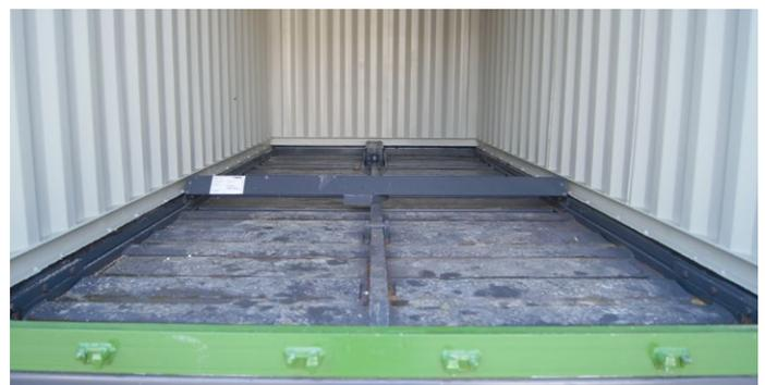
Interior del suelo móvil hidráulico en contenedor
