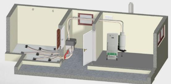
Imagen: Tolva aspiración DIRECT en combinación con 8-puntos de aspiración
