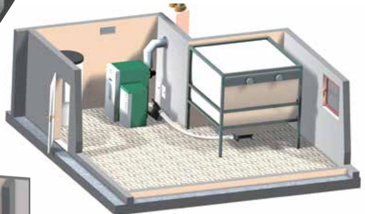
Sistema de extracción mediante sinfín modular (en el almacén de combustible) combinado con el sistema de aspiración: Permite un óptimo vaciado del silo y una total adaptación para cada espacio y situación.
