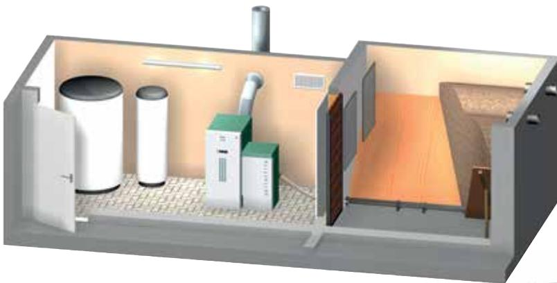
El transporte mediante sinfín flexible es sencillo y ahorra energía en el vaciado del almacén de combustible de una forma eficiente.
