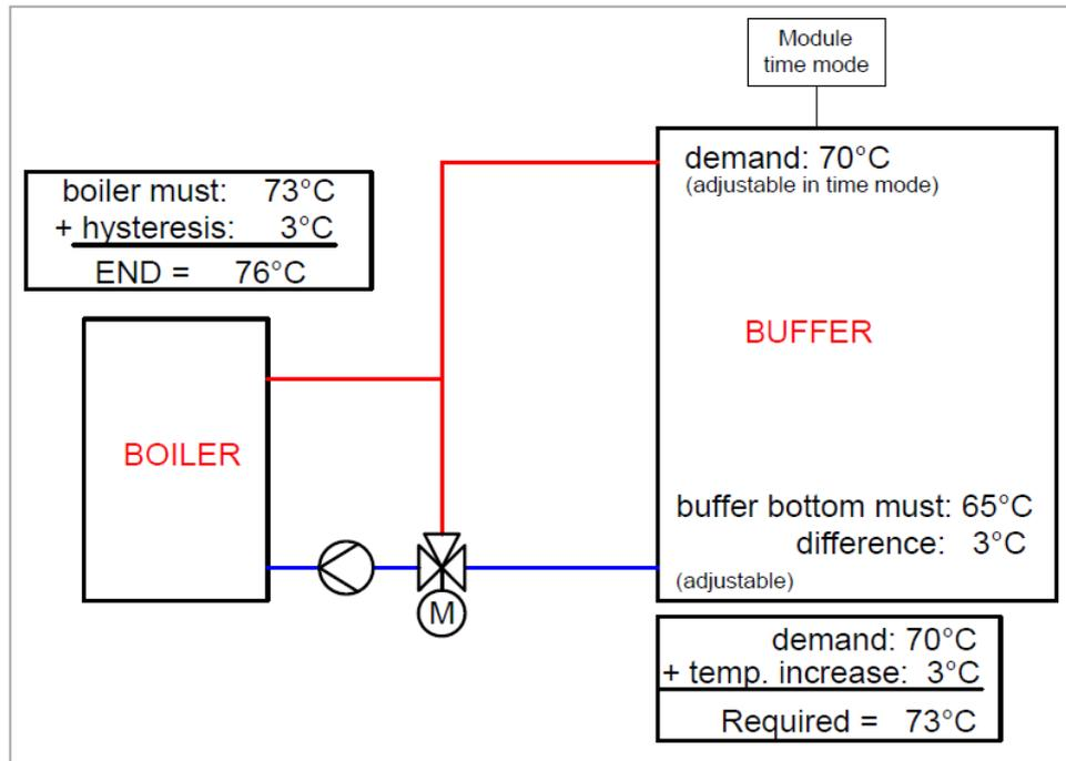
Fig. 8.6: Ejemplo de gestor de temperatura en modo temporizado sin diferencia
