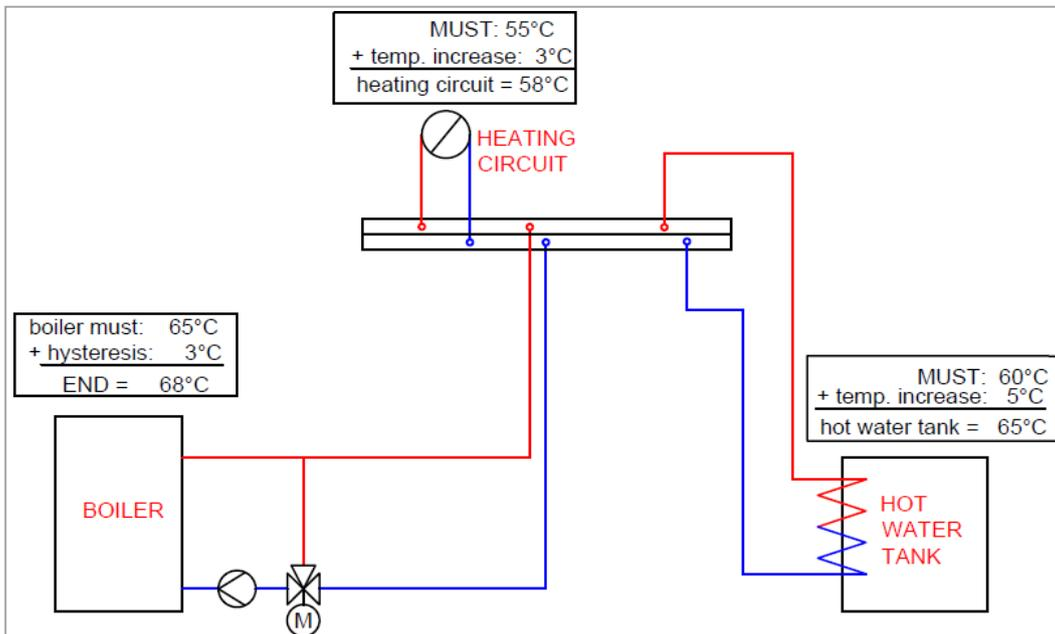
Fig. 8.4: Ejemplo de gestor de temperatura en funcionamiento sin buffer
