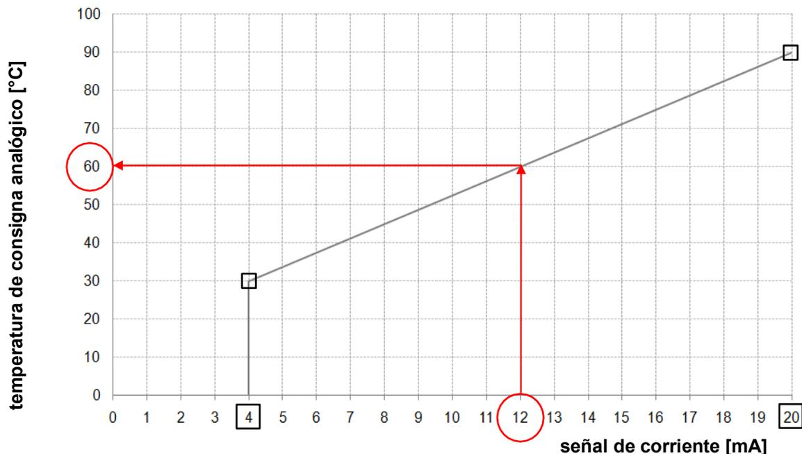
Figura 29.: Temperatura de consigna analógica en función de la señal de corriente aplicada del requerimiento externo
