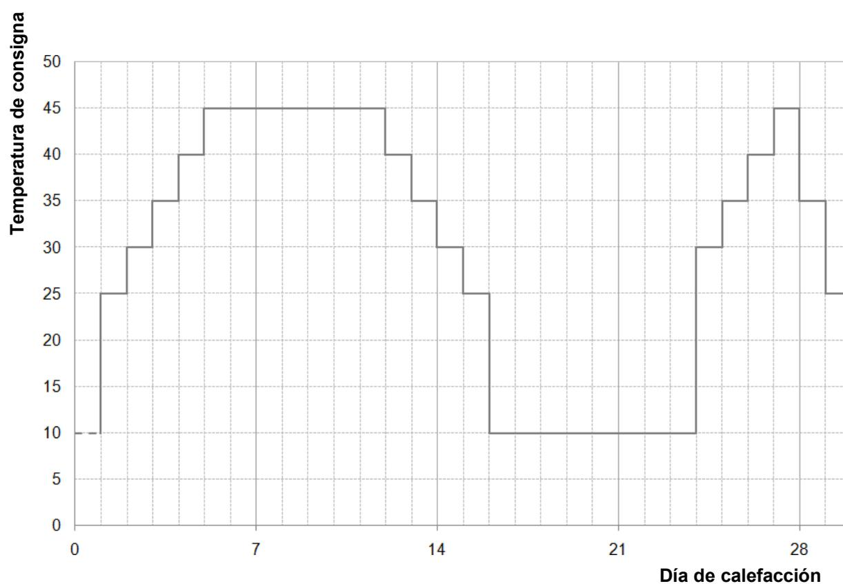
Figura 9. 1 : Temperatura del objetivo en función de los días de en el secado"
