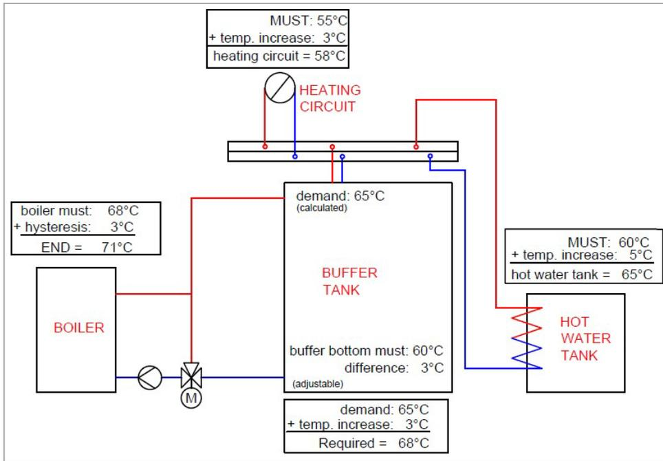
Fig.8.2: Ejemplo de gestor de temperatura con acumulador y sin diferencia
