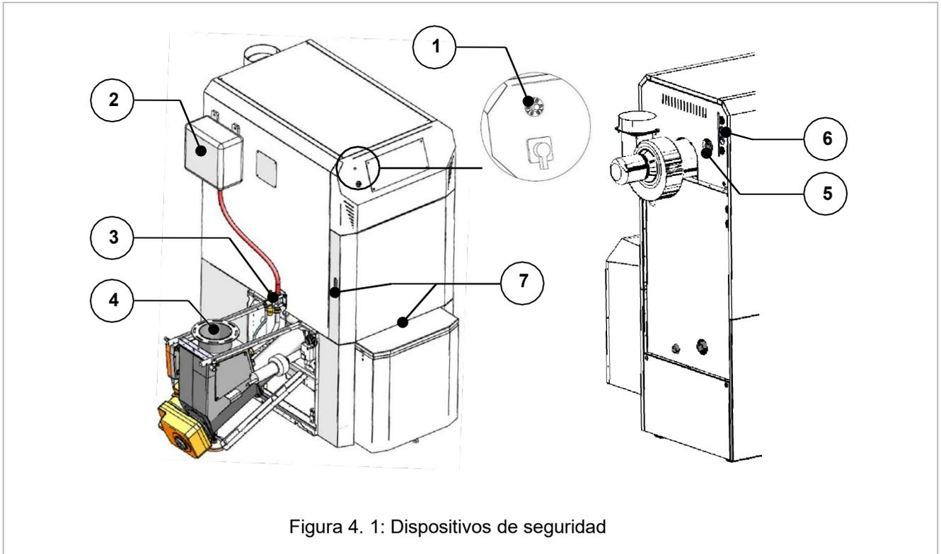
Figura 4. 1: Dispositivos de seguridad
