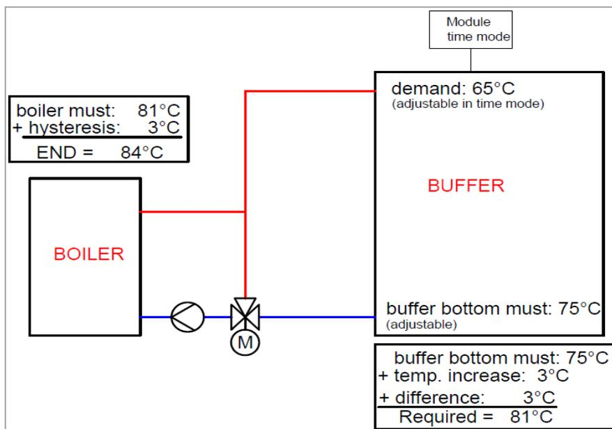
Fig. 8.5: Ejemplo de gestor de temperatura en modo temporizado con diferencia
