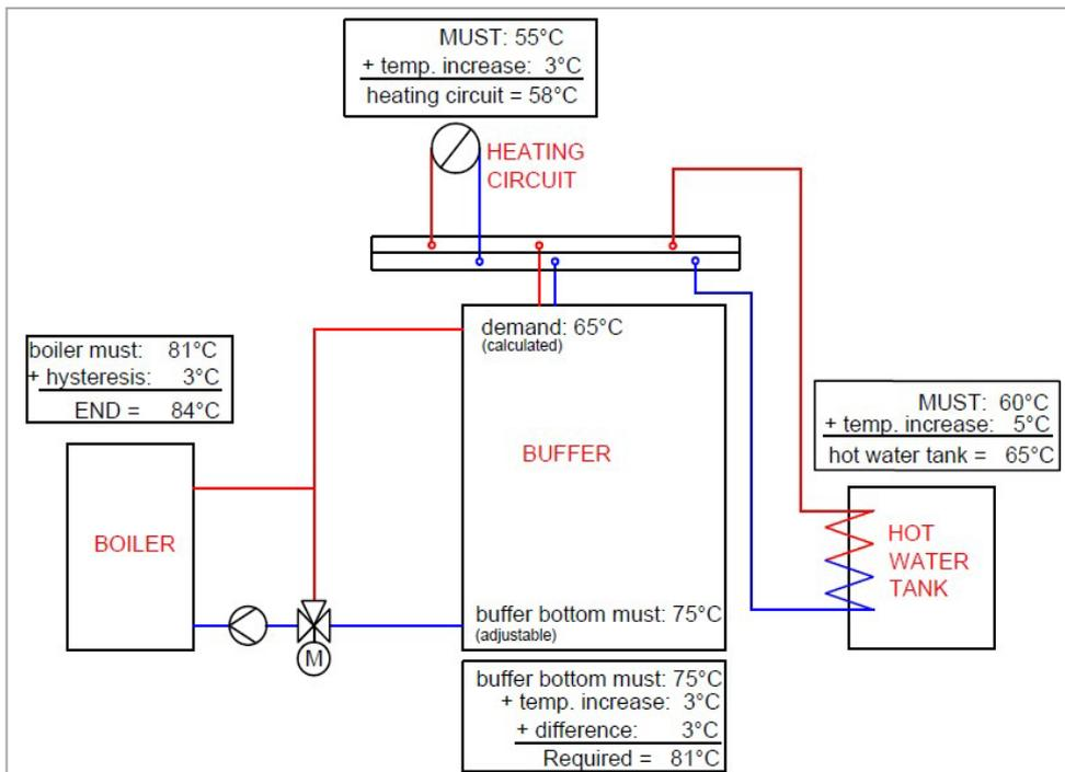
Fig. 8.3: Ejemplo de gestor de temperatura con acumulador y diferencia
