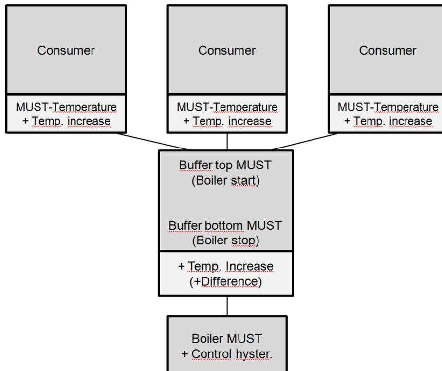
Si la temperatura superior requerida (temperatura requerida) es mayor que la suma de la temperatura inferior y la diferencia ajustada, la temperatura de la caldera requerida es el resultado de la temperatura superior del depósito requerida (temperatura requerida) + el aumento de la temperatura ajustada (ver Fig.8.2). Precaución: Tenga en cuenta el requisito mínimo ajustado..
