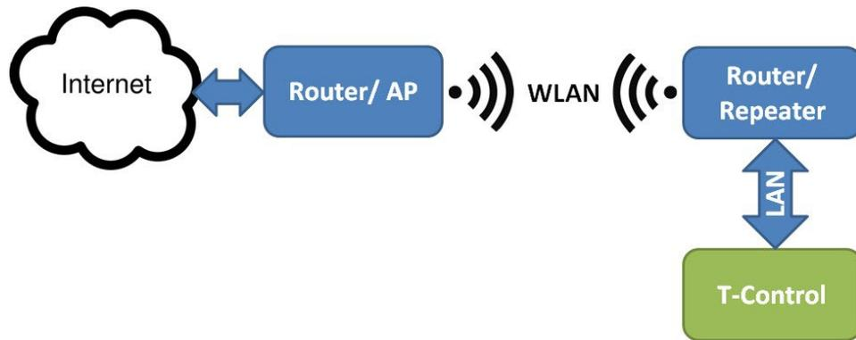
El T-Control se conecta al repetidor o al router a través de Ethernet (LAN). El repetidor o router debe estar configurado para que se comuniquen con el router de Internet a través de WLAN. Después de configurar el repetidor o el router, hay que realizar los ajustes de red en el T-Control.
